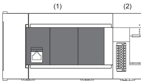
(1) CPU module (FX5U CPU module)
